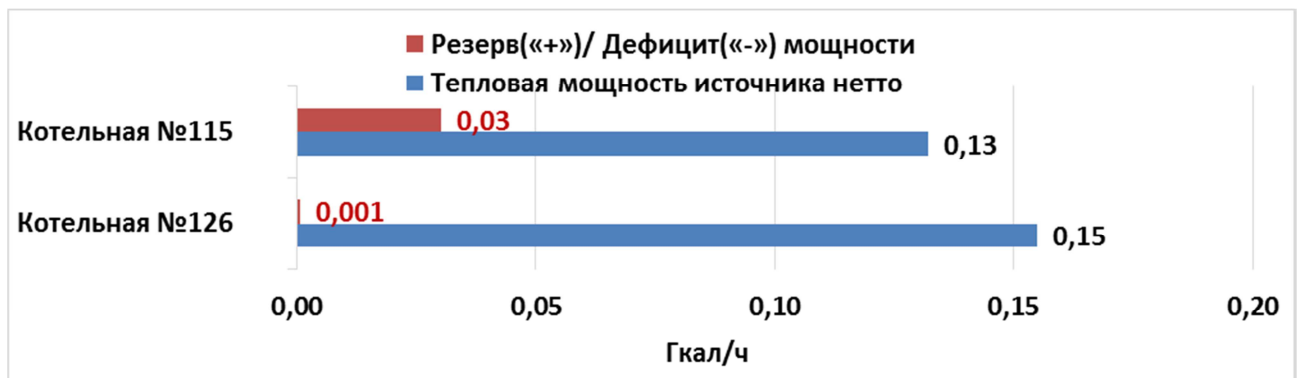
Рисунок 10 – Резервы и дефициты тепловой мощности нетто источников теплоснабжения Юго-Северное СП, ст. Юго-Северная
